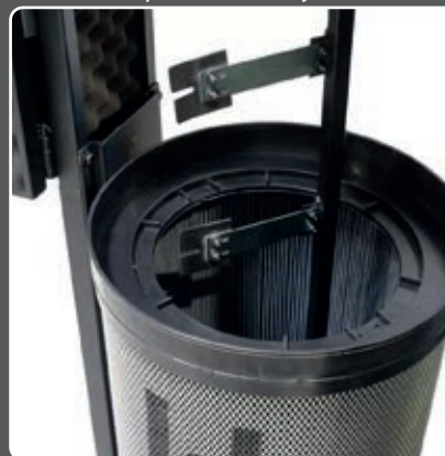
Čistenie filtračného nástavca bez demontáže
