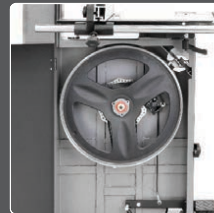
Kotúčová brzda pre rýchle zastavenie
