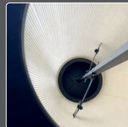
Čistenie filtračného nástavca bez demontáže
