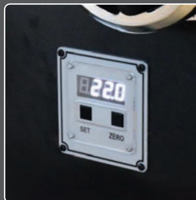
Digitálny ukazovateľ uhla pílového kotúča
