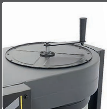
Čistenie filtračného nástavca bez demontáže
