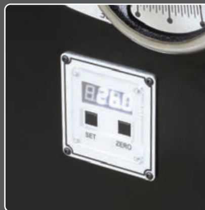
Digitálny ukazovateľ uhla pílového kotúča
