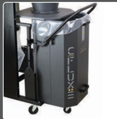
Dômyselný pákový systém pre upnutie odpadového kontajnera
